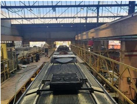
Figura 2.1.2 – Plataforma onde os operários realizam a manutenção da parte superior dos comboios
