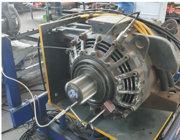
Testagem de vibrações e ruídos a um motor de tração elétrico
