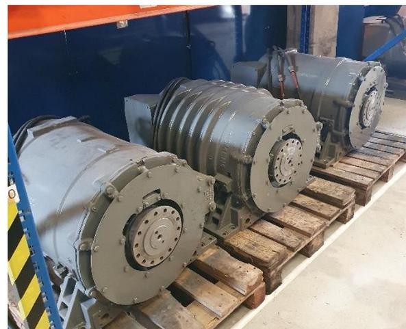
Figura – Motores de tração elétricos de reserva de comboios alfa pendulares.
